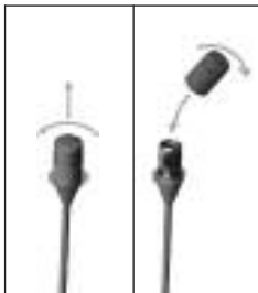
Fig. 10: Montagem do dispositivo de aumento de agudos PB 77
